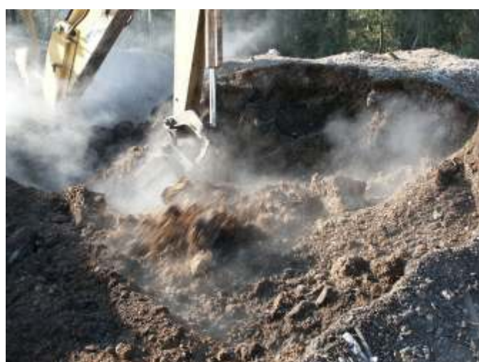
No processo de compostagem as pilhas atingem 70oC
